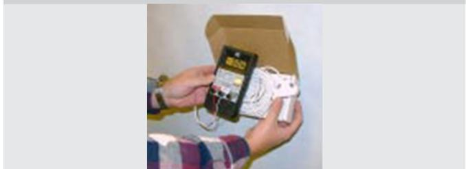
4. Befestigen Sie die L-Cell® lose mit den drei Schrauben, Kabel nach unten. Ziehen Sie die Schrauben nicht fest. Wenn die Spannung außerhalb des Bereichs von -200 bis +200 mV liegt, lösen Sie sofort die Schraube(n). Prüfen Sie ob noch Grate vorhanden sind und entfernen Sie diese sowie andere Oberflächen-Unebenheiten. Wiederholen Sie Schritte 1 bis 5.
