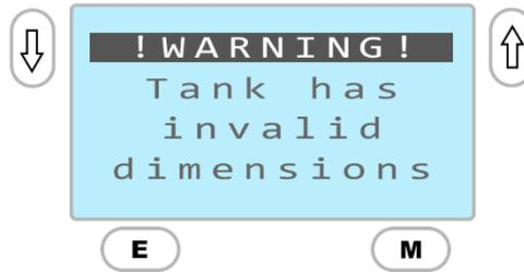
Wenn diese Meldung erscheint, kann das Menü Geometrie (Geometry) nicht verlassen werden, bis der Fehler in den Abmessungen berichtigt oder die Tankgeometrie „Keine“ (None) selektiert wurde.
