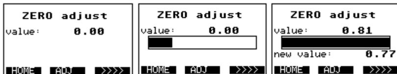
El proceso de medición de "ZERO adjust" (ajuste en cero) se activa cuando se mantiene presionada la tecla **ADJ** por 1,5 segundos. En la línea superior de la pantalla se aprecia el valor actual de ZERO. La barra de progreso indica el estado de avance de la medición. La medición termina cuando la barra de progreso se completa. El nuevo valor de ZERO aparece bajo la barra de progreso antes de ser aplicado.
