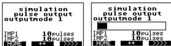
La activación de la función **++** dará comienzo a la simulación. Para el caso de la salida de impulso, una barra de progreso indicará la duración de la prueba y cuándo ésta esté completa (luego de 1 minuto). El medidor habrá dado una salida de un determinado número de impulsos. En cuanto a la pantalla actual, está finalizará cuando la pantalla cambie.
