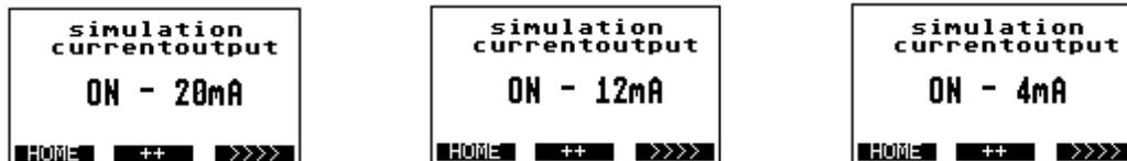
Mediante la tecla **++** se puede establecer la salida con tres configuraciones distintas. La primera salida será de 20 mA, al accionar nuevamente la tecla **++** ésta pasará a ser de 12 mA y con otro accionamiento más la salida será de 4 mA. Al abandonar esta pantalla la simulación de salida habrá terminado.
