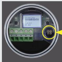
Plugue de conexão para o adaptador MPI-200-F como um plugue intermediário entre a eletrônica ILM-4 e a conexão MPI-200 (3) (veja a figura abaixo).
