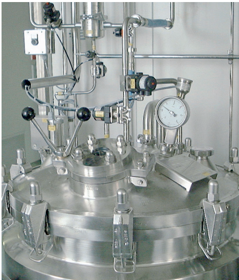
Sonde de température avec système de montage aseptique PHARMadapt EPA
