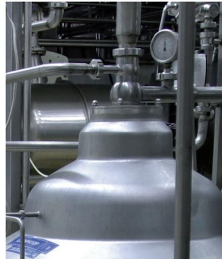
Kompakt-Manometer 63 mm mit hygienischem Einbausystem CLEANadapt
