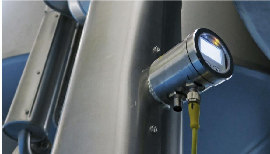
Induktiver Leitfähigkeitssensor in modularem Design
