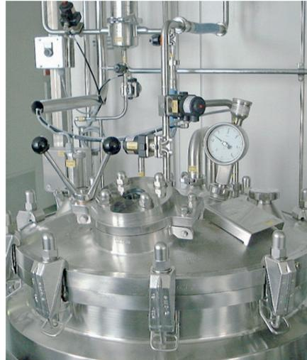
Temperaturfühler mit aseptischem Einbausystem PHARMadapt EPA
