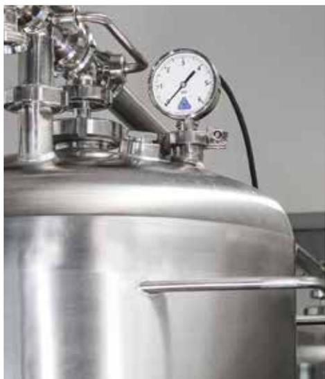
Манометр 90 мм с возможностью подключения напрямую
