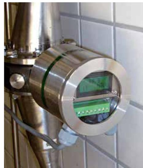
Датчик мутности (4-х потоковый прерывистый свет)
