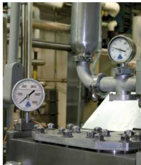
Манометр со встроенным передатчиком для гомогенизаторов
