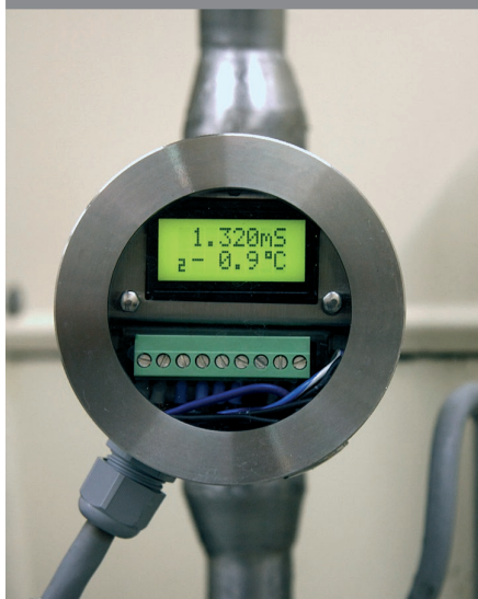
Zdj. 2: Stały pomiar przewodności w zbiorniku reakcyjnym z miernikiem przewodności ILM-2 firmy NEGELE
