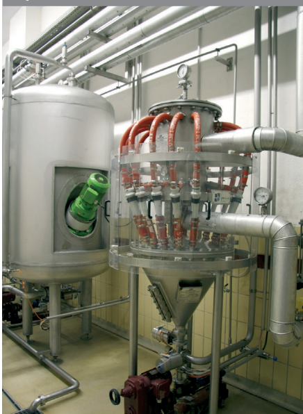
Zdj. 1: Po lewej: Zbiornik magazynowy kryształów kamienia winnego, z przodu: Wirówka Venturi
