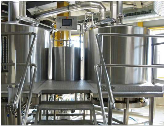
Cuve de moût et la cuve de clarification avec TFP et FMQ
