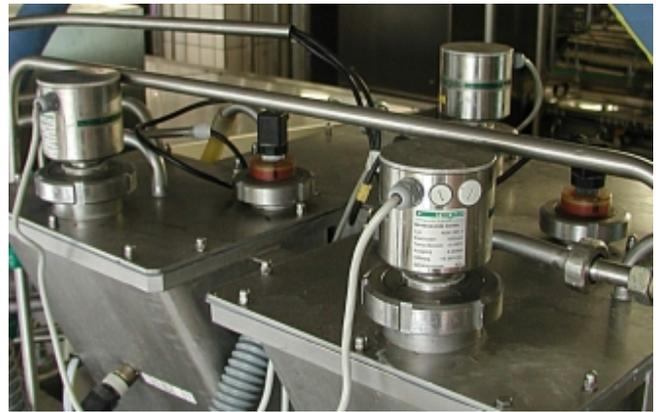
**Bild 3: NSK-Sonden in einer Abfüllmaschine für Quark und Joghurt**
