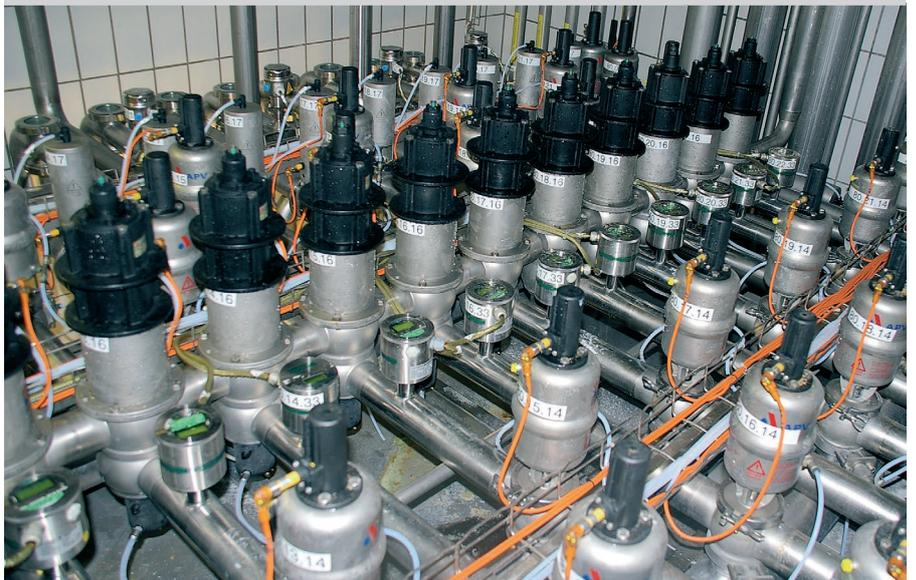
Lors du démarrage ou de la vidange ou lors du transfert par pompage à partir de cuves, il est nécessaire de distinguer le produit laitier de l'eau de vidange remplie dans la conduite.
