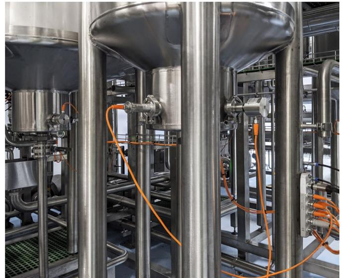
Avec des capteurs IO-Link pour la température, la turbidité, la conductivité, le niveau, le débit et la pression, Anderson-Negele propose une offre importante. La technologie Flex-Hybrid permet une fonction en parallèle en numérique et en analogique (IO-Link et 4...20 mA).
