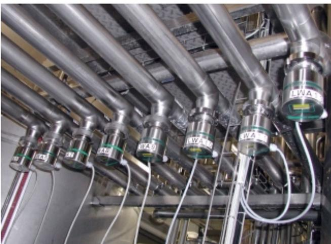
**Leitfähigkeitsmessgeräte ILM-2** im CIP-Rücklauf zur Trennung von Reinigungsmedien. Ein Gerät je CIP-Kreislauf. Abhängig von der Leitfähigkeit wird das im Rohr befindliche Medium erkannt und in den richtigen CIP-Behälter zurück geleitet.
