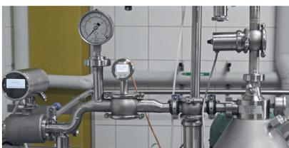
Frontbündiger kompakter Sensor ITM-51, Messbereich 200...300.000 NTU, einfachste hygienische Installation (Clamp- oder Schraubanschluss), hier installiert in einem Separator.
