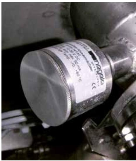
Емкостный датчик предельного уровня для трубопроводов, а также резервуаров с одинарной и двойной стенкой
