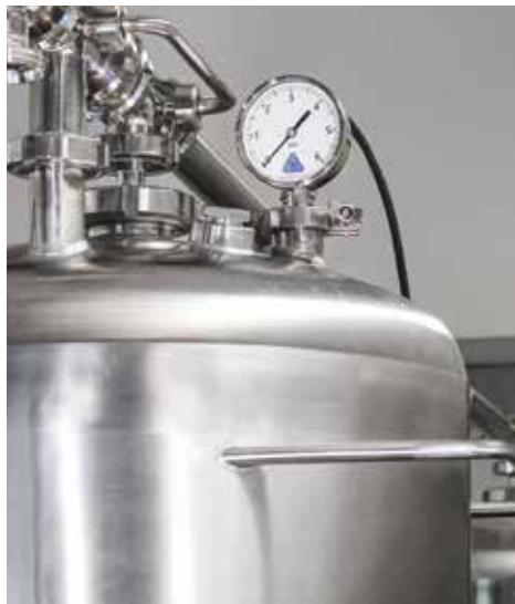
Манометр 90 мм с возможностью подключения напрямую
