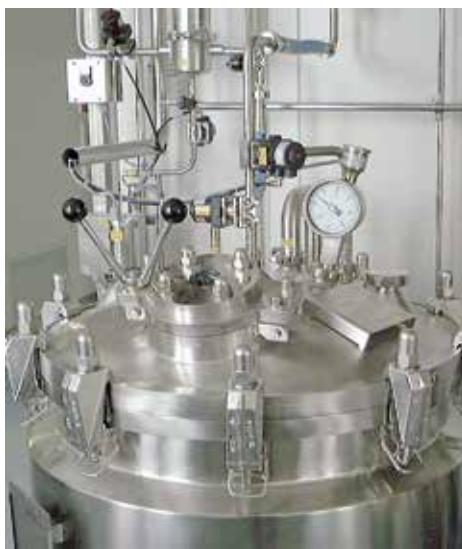
Компактный манометр 63 мм
