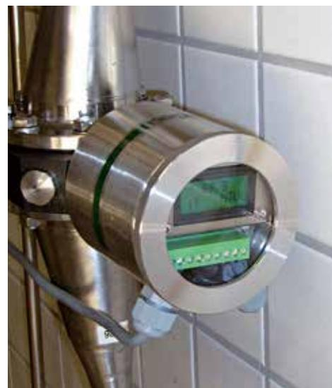
Датчик мутности (4-х потоковый прерывистый свет)
