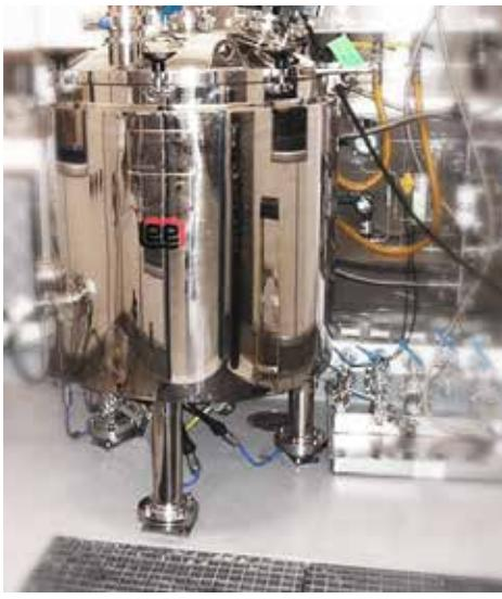
Модули взвешивания Load Disc
