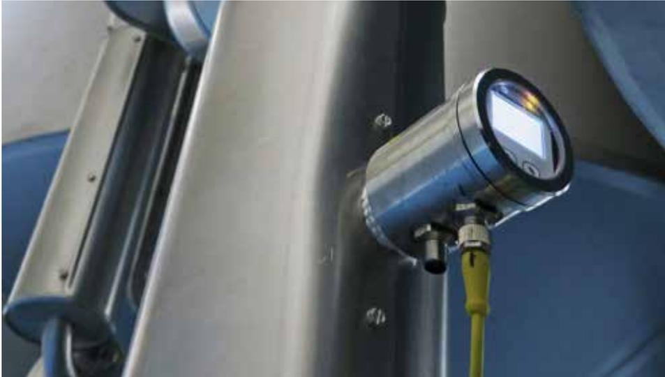
Измерение концентрации жидкостей внутри трубопроводов
