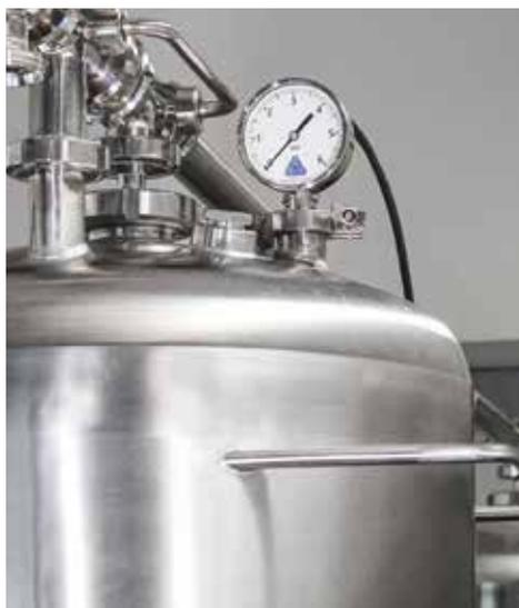
Манометр 90 мм с возможностью подключения напрямую
