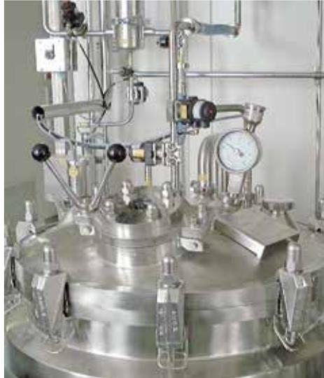
Температурный датчик с асептической монтажной системой PHARMadapt EPA
