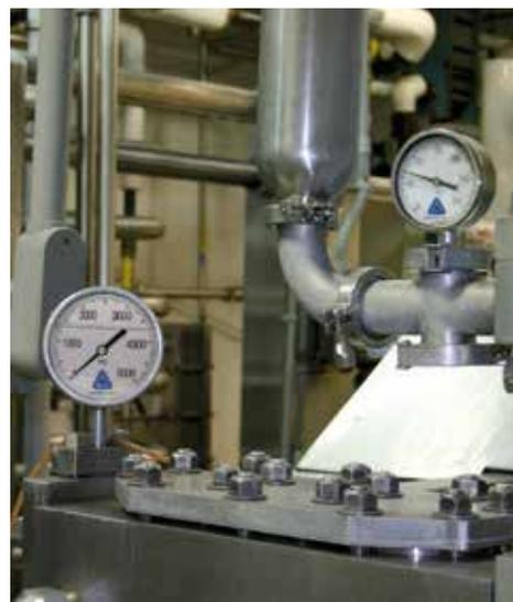
Манометр со встроенным передатчиком для гомогенизаторов
