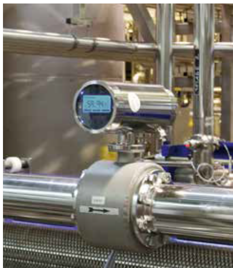
Medição de vazão no flash do pasteurizador
