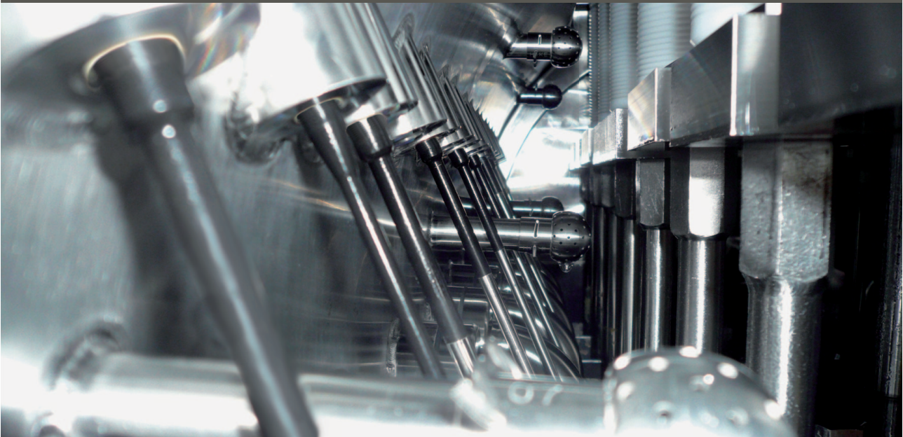
Abb. 3: NSK-187 mit PFA-Beschichtung im Doseur
