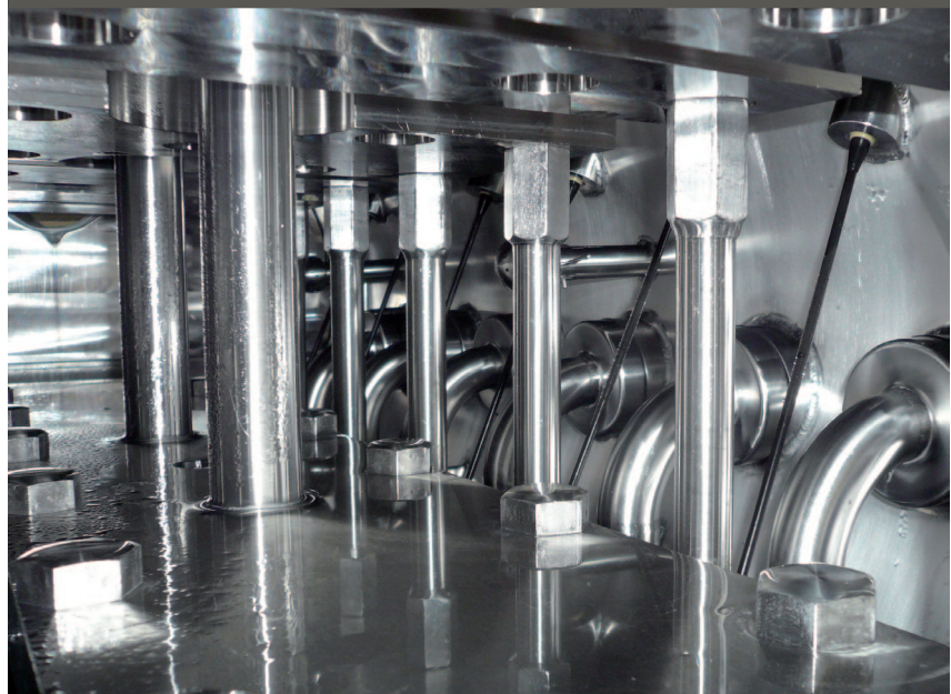
Abb. 4: NVS-186 mit PFA-Beschichtung im Doseur
