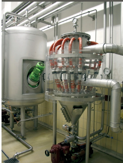
Abb. 1: Links: Vorratstank für die Weinstein-Impfkristalle Vorne: Venturi-Zentrifuge
