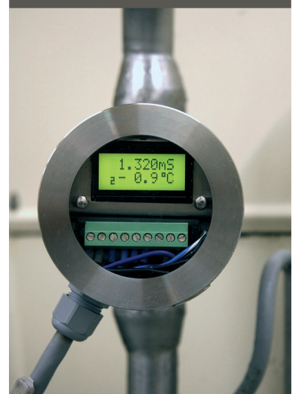
Abb. 2: Kontinuierliche Leitfähigkeitsmessung am Reaktionstank mit induktivem Leitwertmesser ILM-2 von NEGELE
